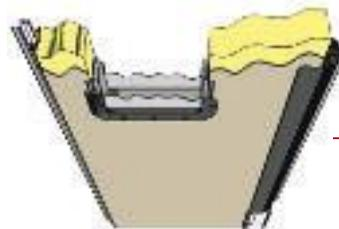
**Âme en uréthane sans CFC** - Moussé sur place pour assurer un lien solide entre l'uréthane et le polyéthylène, elle offre isolation thermique de 30% à 40% supérieur à l'isolation en styrène. La durabilité du panneau est supérieur au porte qui sont collés et rivetés ensembles.
