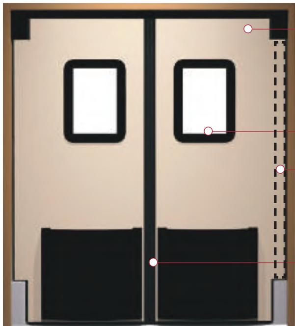
**Panneau de Porte** – Faites d'un matériau léger, pour faciliter l'ouverture, assurer un fonctionnement en douceur et permettre le passage en toute sécurité du personnel et de l'équipement. Panneau construit à une épaisseur uniforme de 1/8 po en dimensions allant jusqu'à 8 x 8 pi. Revêtement extérieur en polyéthylène réticulé de 1/8 po d'épaisseur conservant ses propriétés jusqu'à -40°F.
