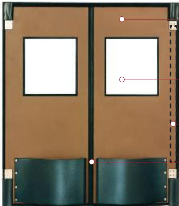
**Panneau de Porte** – Faites d'un matériau léger, pesant 2.5 livres par pied carré, pour faciliter l'ouverture, assurer un fonctionnement en douceur et permettre le passage en toute sécurité du personnel et de l'équipement. Panneau construit à une épaisseur uniforme de 1 7/8 po en dimensions allant jusqu'à 8 x 8 pi. Revêtement extérieur en polyéthylène réticulé de 1/8 po d'épaisseur conservant ses propriétés jusqu'à -40°F.
