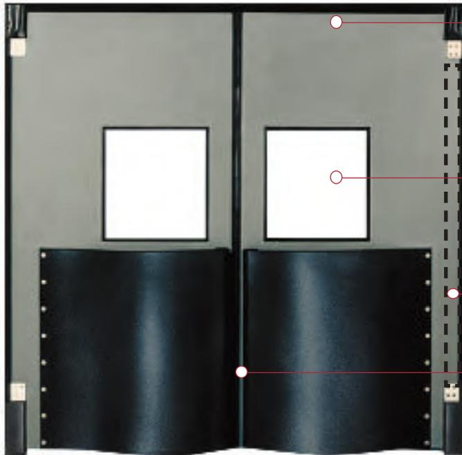
**Panneau de Porte** – Faites d'un matériau léger, pesant 3.5 livres par pied carré, pour faciliter l'ouverture, assurer un fonctionnement en douceur et permettre le passage en toute sécurité du personnel et de l'équipement. Panneau construit à une épaisseur uniforme de 1 7/8 po en dimensions allant jusqu'à 10 x 10 pi. Revêtement extérieur en polyéthylène réticulé de 1/4" po d'épaisseur conservant ses propriétés jusqu'à -40°F.
